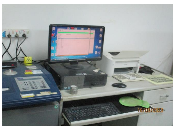
รูปที่ 6 เครื่องวิเคราะห์คุณภาพดินผง (X-Ray Analyzer)
